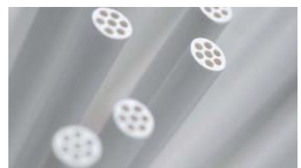
過濾纖維橫剖面：包含七根毛細管的蜂巢結構能夠穩定纖維，防止產生可被病原體穿透的微小裂縫。
