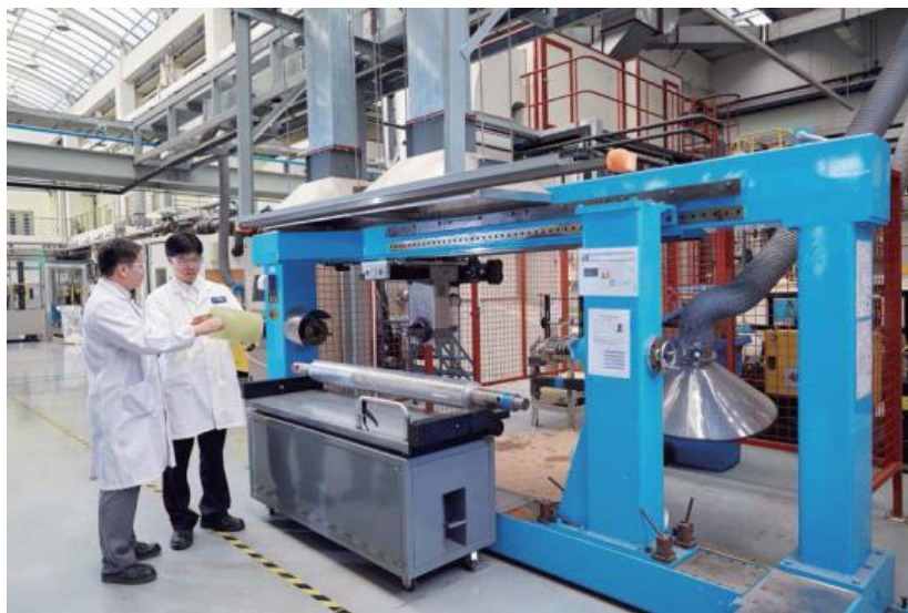
這台機器用於複合材料纏繞工藝的測試。
