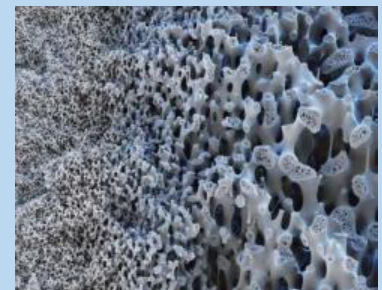
水穿透濾膜表面後，就可以透過多孔塑膠流到外面。
